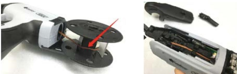
Abra a tampa frontal e retire a placa prensada.
