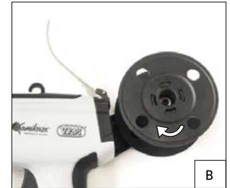
B. Presione hacia abajo la cubierta para girar de acuerdo con la dirección de la flecha, retire la cubierta.
