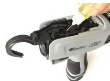
Após a conclusão do processo de limpeza, lubrifique com óleo lubrificante (óleo branco comum ou óleo de máquina) no cortador e em cada junta móvel conforme mostrado na figura.
