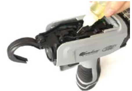
Después de completar la limpieza, lubrique ligeramente las partes móviles, nunca lubrique el canal ni los dientes de arrastre del hilo ni los rodillos.
