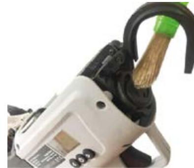
Utilice un cepillo para limpiar restos en el área del cable de unión del extremo delantero.
