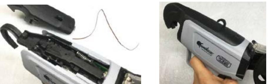
Insira o carro do prensa-fio e coloque a tampa frontal corretamente e continue a trabalhar com o novo arrame.
