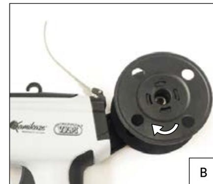
B. Appuyez sur le couvercle pour le faire pivoter dans le sens de la flèche, retirez le couvercle.
