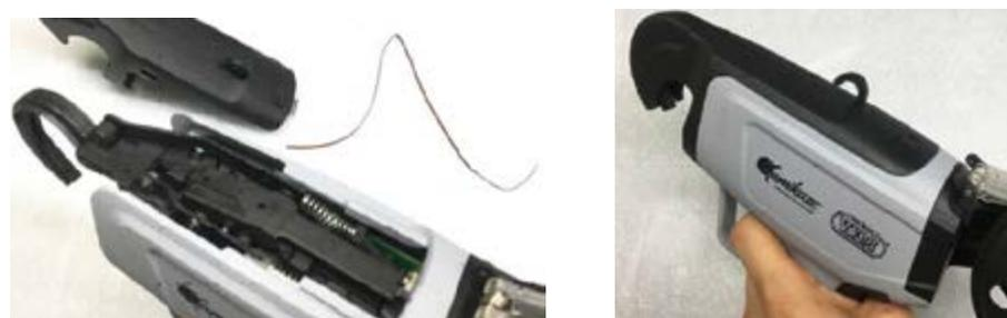
Inserire il carrello pressa filo e posizionare correttamente la cover anteriore. La macchina può continuare a lavorare con il nuovo filo.
