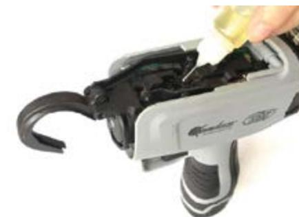
Une fois le nettoyage est terminé, lubrifiez légèrement les pièces mobiles, ne jamais lubrifier le canal ou les dents de traction du fil ou les rouleaux
