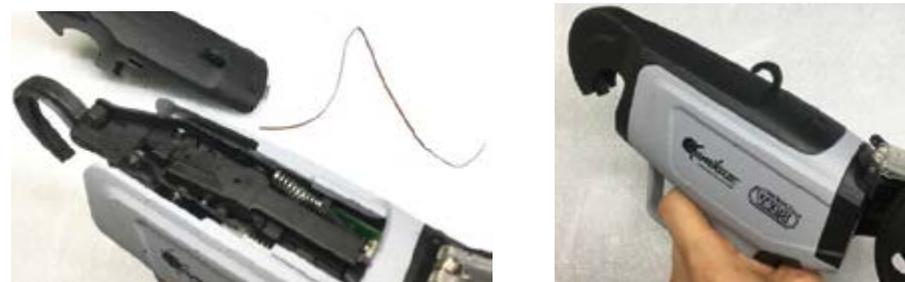
Instale la rueda de presión de alambre y coloque bien la cubierta superior. La máquina puede seguir trabajando con el nuevo cable.
